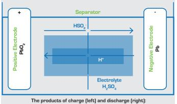
$PbO_{a} + Pb + 2H_{a}SO_{a} \leftrightarrow 2PbSO_{a} + 2H_{a}O$
